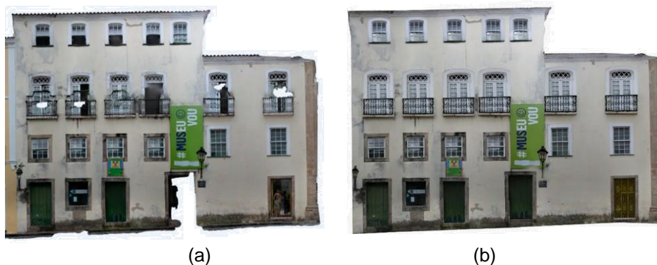
Figura 5 – (a) Ortofoto gerada no Photoscan (b) Ortofoto editada no Photoshop e com a substituição de grades e janelas geradas no PhotoModeler
