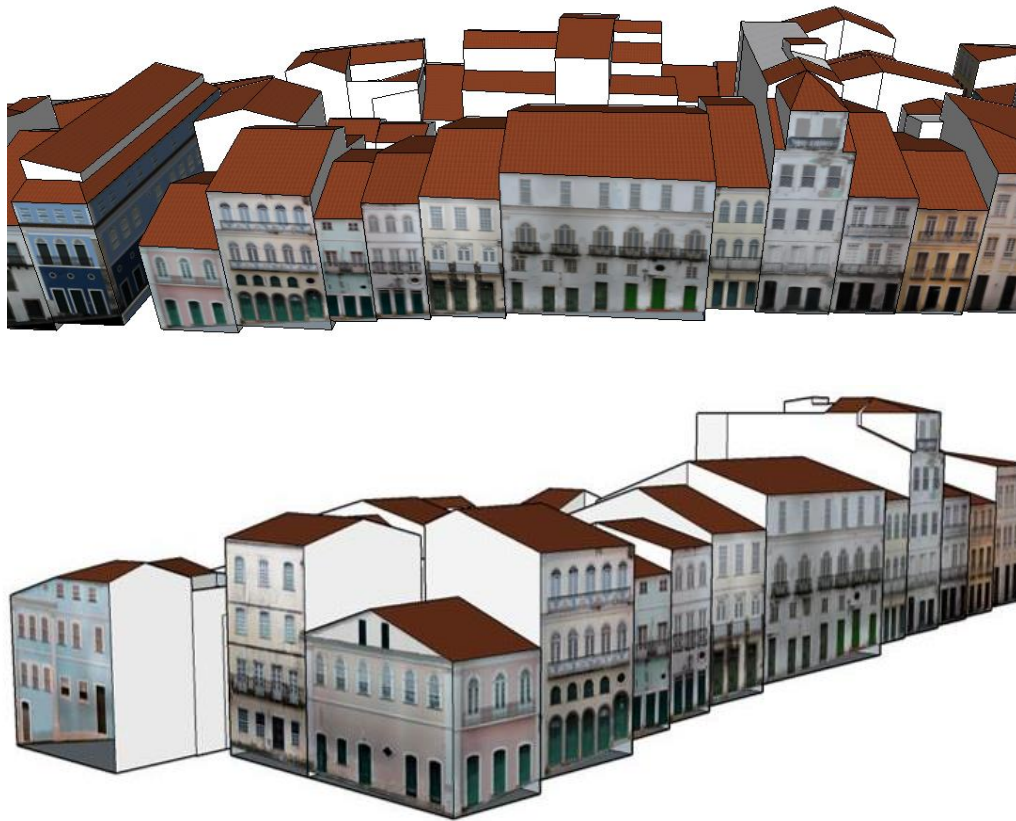
Figura 11 – Duas perspectivas ilustrando o modelo do Pelourinho no SketchUp com aplicação das ortofotos das fachadas e texturas genéricas no telhados
