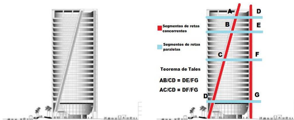
Figura 6 – Desenho, adaptado pelo primeiro autor, da fachada oeste do edifício Acqua Corporate. Fonte: Disponível em: http://tiny.cc/946tuz (Acessado em: 05/02/22).
