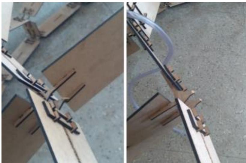
**Figura 16** – Identificação do colapso do sistema estrutural
