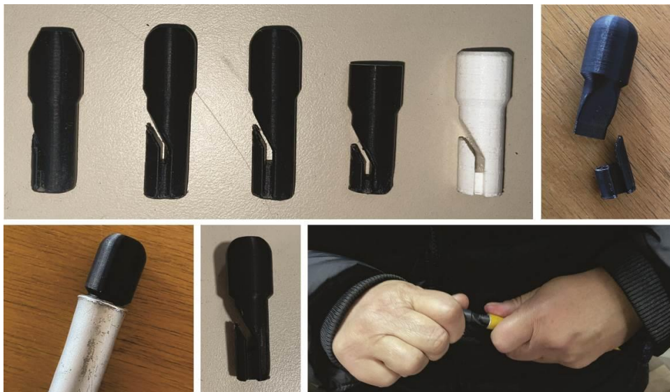
Figura 1 - Da esquerda para a direita: iterações anteriores da peça para teste, uma das iterações quebradas devido a fragilidade, peça final inserida na ponta da bengala, peça final, peça final sendo colocada na bengala para teste na escola. Fonte: Autores
