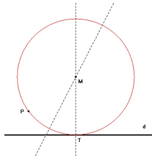
Fig. 3 -  $M$  é um dos pontos do plano que se situam a igual distância do ponto  $P$  e da reta  $d$ .
