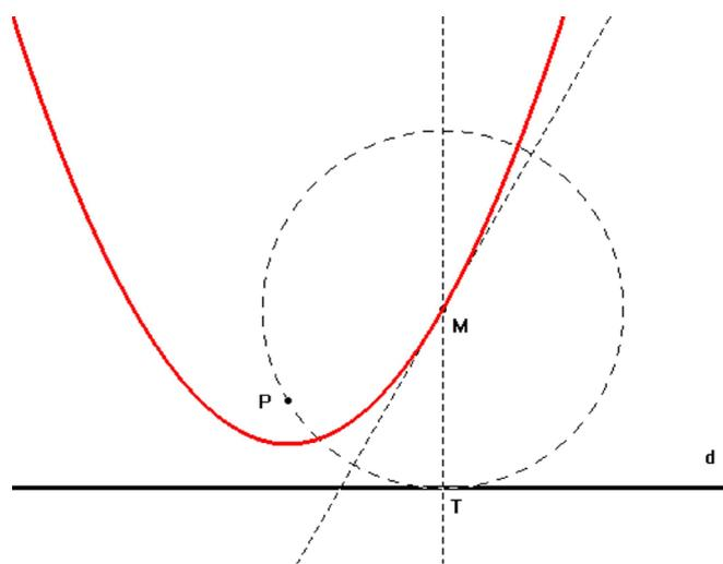
Fig. 4 - A parábola representada é o lugar geométrico dos pontos do plano que se situam a igual distância do ponto  $P$  e da reta  $d$ .
