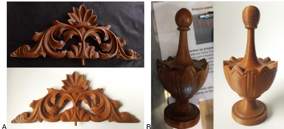
Figura 9 – A. Acima o frontão original e abaixo o modelo produzido por impressão 3D na escala 1/2. B. À esquerda a pinha original e à direita o modelo produzido por impressão 3D na escala 1/1. Fonte: Autores, 2019.
