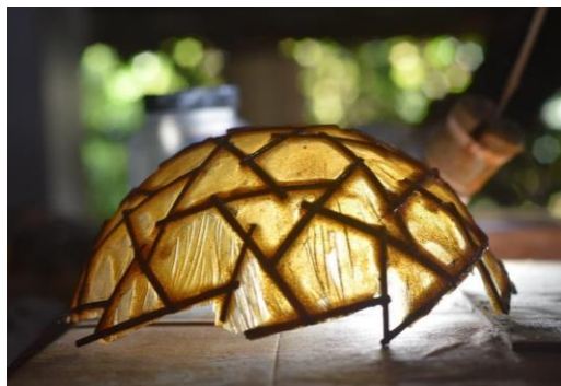
Figuras 4 y 5 – Modelo a escala estructura colaborante cubierta con resina natural (LILD). Análisis de deformación en superficies mínimas estimulado por frecuencias sonoras . Fuente: Autores
