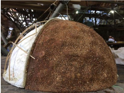
Figuras 2 y 3 - Maqueta domo acústico construido con fibras bambú, barro y resina de mamona. Detalle embarrillado y nudo escondido en estructuras colaborantes en Bambú phyllostachys aurea Fuente: Autores
