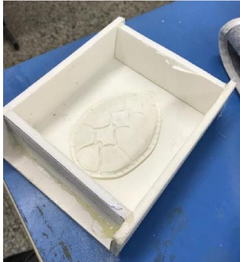
Figura 11 - Fixação do casco. Fonte: Autores
